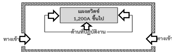
รูปที่ 8.8 แสดงทางเข้าไปยังพื้นที่ว่างเพื่อปฏิบัติงานทั้ง 2 ข้างของแผงสวิตช์
