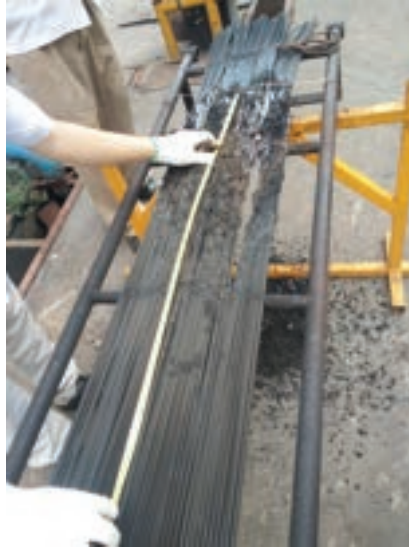
รูปที่ 2.5 การวัดระยะการเผาไหม้หลังทำการทดสอบการเผา
