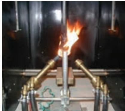
รูปที่ 2.2(ข) การเผาสายไฟฟ้าด้วยเปลวเพลิง
