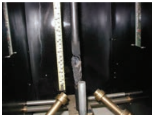
รูปที่ 2.3 การวัดระยะการลามไฟ (การต้านทานเปลวเพลิงระดับต่ำ)
