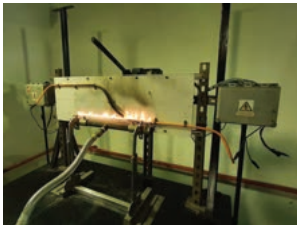
รูปที่ 2.11 การทดสอบ resistance to fire with mechanical shock
